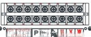
Diagrama esquemático de terminales del circuito principal y de control 45-75KW
